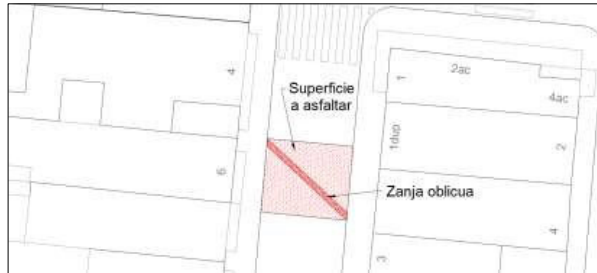
Figura 1. Afección 1 carril. Superficie mínima a asfaltar.
