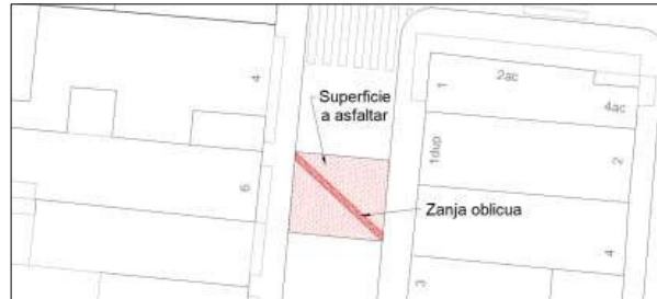
Figura 1. Afecció 1 carril. Superfície mínima a asfaltar.
