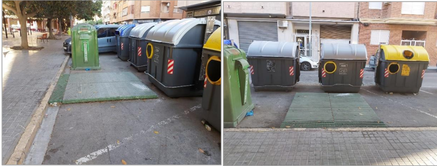
Figura 2. Ejemplo de solución para la mejora de la accesibilidad a los contenedores.
